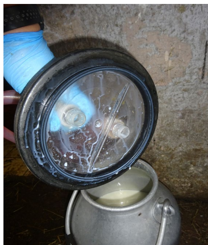
Abb.: Zu kleiner Trennsteg am Kannendeckel und zu kleine Milchkanne
