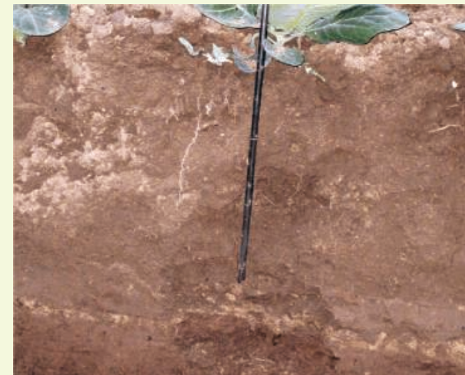
Aufspüren einer Pflugsohle mit der Bodensonde
