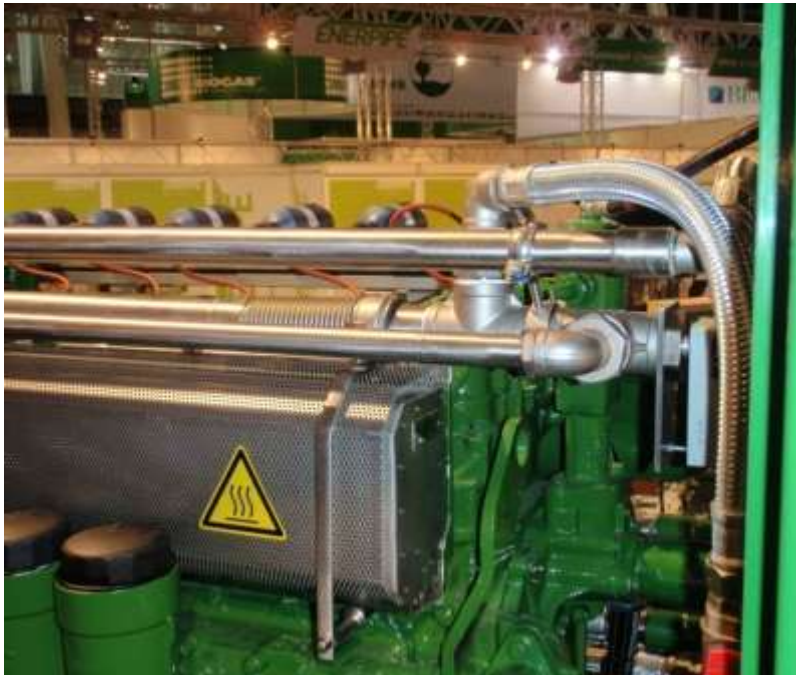
Wirkungsgradoptimierung durch Leistungsregelung via (cooled exhaust gas) Waste Gate
