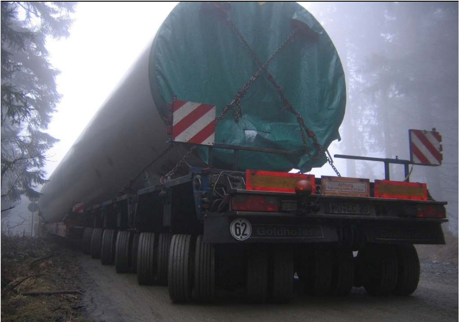
Anlieferung eines Stahlrohrsegmentes
