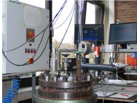
Autoklav, Volumen 25 L, mit Steuerung
