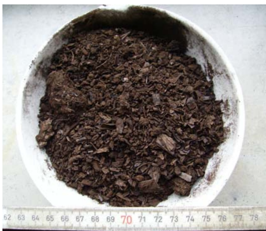
Getrocknete HTC-Biokohle aus dem Standard I (Rübenschrot und Maissilage)
