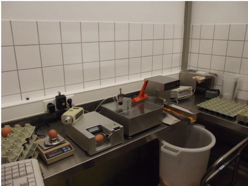
Abb. 4: Messstrecke zur Erfassung der Eiqualitätsparameter: Eigewicht, Bruchfestigkeit, Schalenfarbe, Eiklarhöhe, Dotterfarbe, Ei-Einschlüsse
